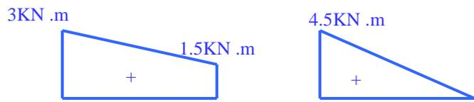
$$\delta = \frac{1}{EI} \left[ \frac{1}{6} (\text{le triangle} = 4.5) \cdot (\text{le trapèze} = 2.3 + 1.5) \cdot (\text{la longueur} = 3) \right]$$
